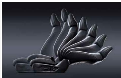
Asiento del conductor con ajuste eléctrico de 10 posiciones\*<sup>2</sup>
